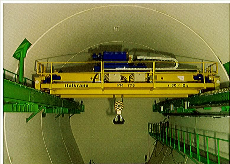
Gru a ponte bitrave per Laboratorio Ricerca Nucleare - Portata 30/2 t Bridge Crane for Nuclear Field - Capacity 30/2 t
