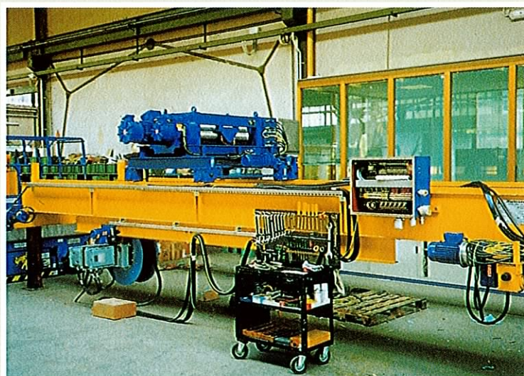
Gru a ponte bitrave in fase di finitura Double-Girder crane in final stage
